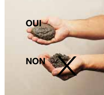
Détermination de la consistance adéquate du mélange Mapecem
