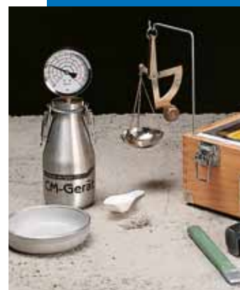
Mesure de l'humidité de la chape Mapecem avec hygromètre à carbure
